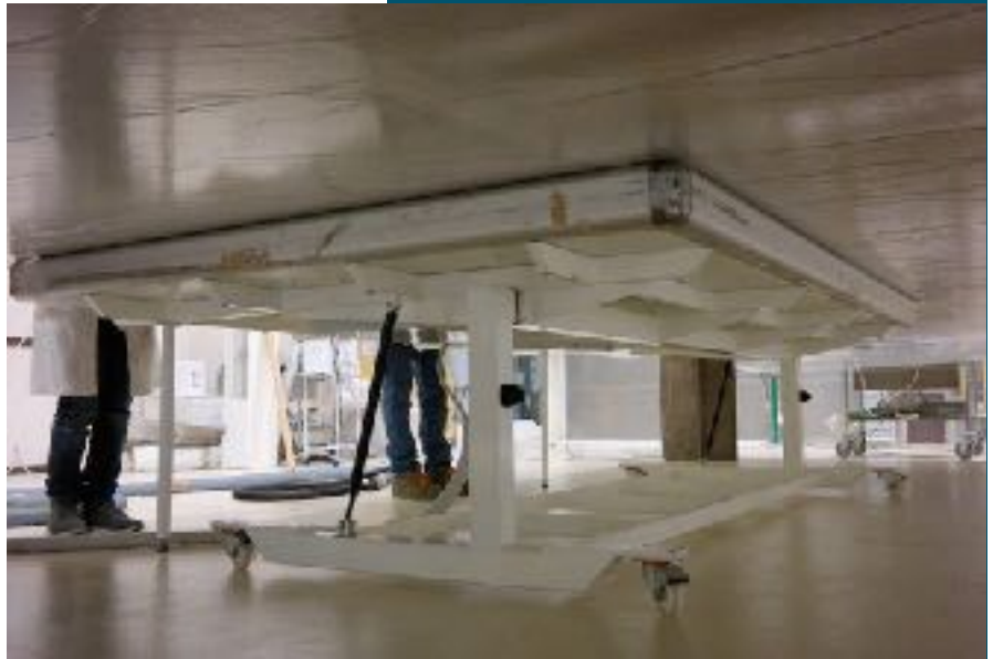
Fig. 13 : Table basse pression pour la réactivation de l'adhésif à la chaleur - © Vito FERRANTE
